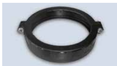
Beslag med dimensioner svarende til DN/UD 90 eller større er udstyret med 2 skruer. Det maksimale tilladte tilspændingsmoment er 7 Nm. (FIGUR 4)
