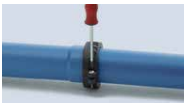
Spænd derefter skruen. Det maksimale tilladte tilspændingsmoment er 7 Nm. Fittings med dimensionerne DN/UD 32–90 skal trækkes 5 mm fra hinanden, før POLO-KAL NG ASV monteres. (FIGUR 3)
